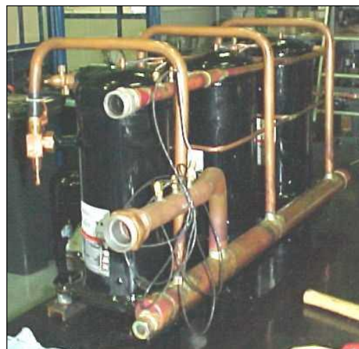
Рис. 4: Конструкция всасывающего коллектора
