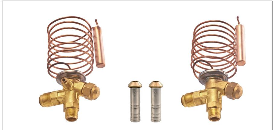
Клапаны терморегулирующие T2 и TE2 предназначены для автоматического регулирования расхода холодильного агента, поступающего в испаритель холодильной установки, в зависимости от перегрева пара, выходящего из испарителя.
