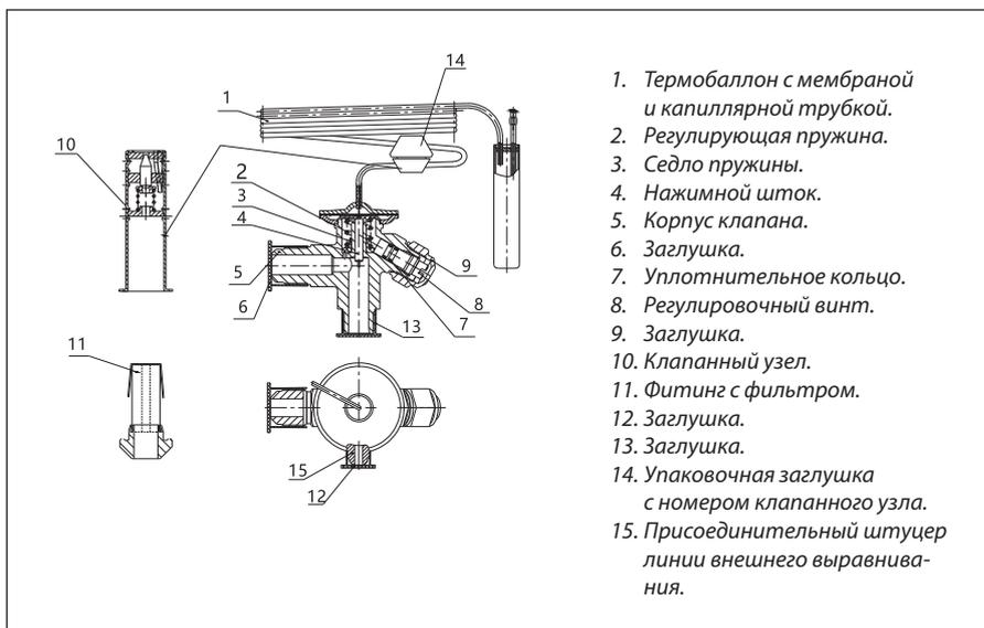
1. Термобаллон с мембраной и капиллярной трубкой.
