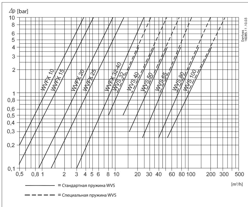
Отклонение (повышение давления конденсации) для клапанов регуляторов давления
