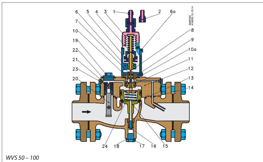
Клапаны WVS 32 – 40 имеют штуцеры подвода воды с внутренней резьбой BSP, а клапаны WVS 50 – 100 могут поставляться либо со штуцерами с резьбой BSP, либо со штуцерами под сварку.
