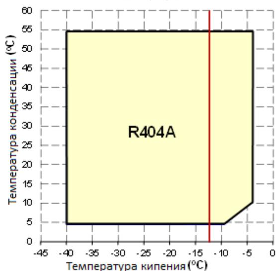
Температура всасываемого газа  $\leq 20^{\circ}\text{C}$
