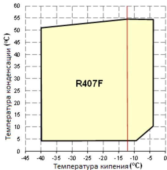
Температура всасываемого газа  $\leq 20^{\circ}\text{C}$
