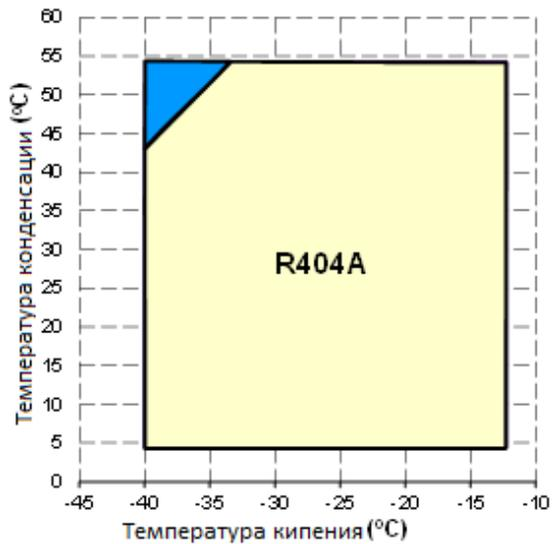
Температура всасываемого газа  $\leq 20^{\circ}\text{C}$
