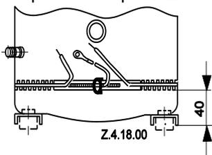
Если нагреватель картера установлен, его следует включать за 12 часов до пуска компрессора. Это предотвратит разжижение масла и повреждение подшипников при пуске. При выключении компрессора цепь подогревателя картера должна оставаться замкнутой. Нагреватель картера должен быть установлен на картере компрессора ниже клапана Шредера, как показано на **Рис. 12**.
