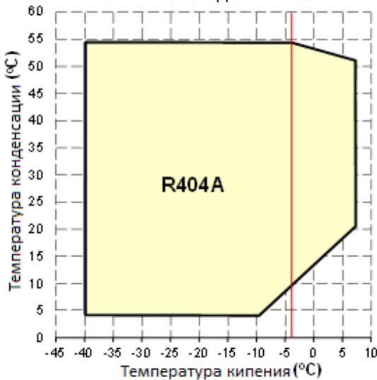
Температура всасываемого газа  $\leq 20^{\circ}\text{C}$
