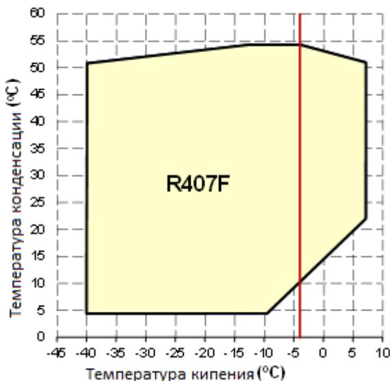
Температура всасываемого газа  $\leq 20^{\circ}\text{C}$
