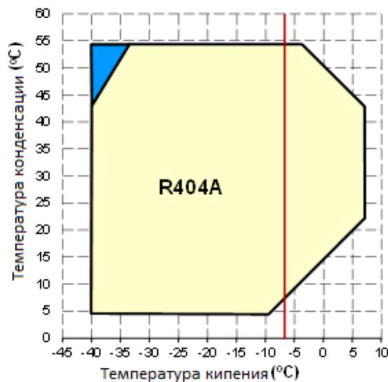
Температура всасываемого газа  $\leq 20^{\circ}\text{C}$
