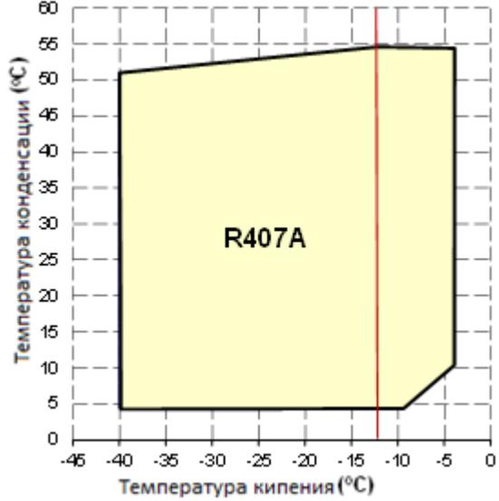
Температура всасываемого газа  $\leq 20^{\circ}\text{C}$
