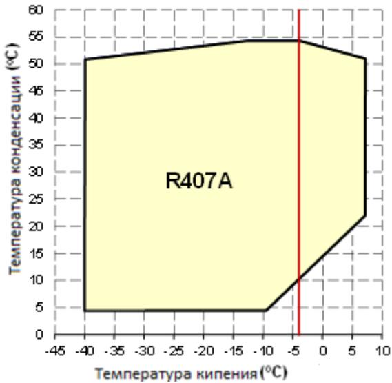
Температура всасываемого газа  $\leq 20^{\circ}\text{C}$
